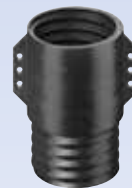
Stelzlagerverlängerung SBP für zusätzlich 60 bis 90 mm Höhe, passend für Stelzlager SB Plus fix und SB Plus nivellierend
